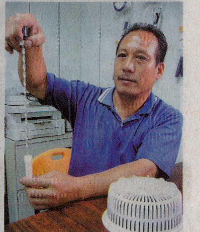
←↑拖神只需用手壓，拖盤布會自動旋轉瀝乾；秘訣就是靠一根螺桿，造成上下直線運動甩水。（記者湯佳玲攝）
